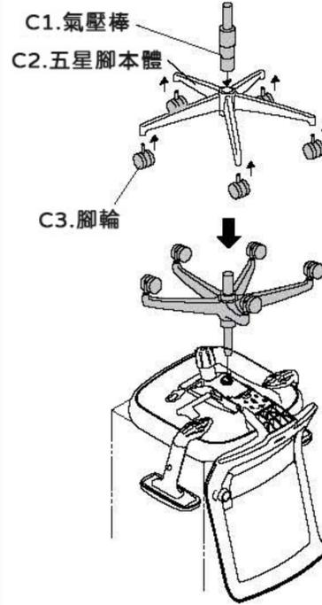
(1)將腳輪插入五星腳5個腳端孔內。
