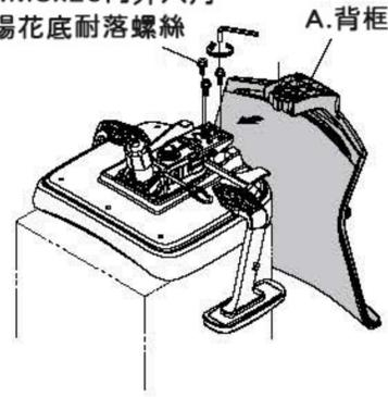
將背框插入底盤的尾版，推到底後，用M8x20內外六角螺絲進行固定。
