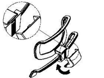
(4). 蓋板頂部的定位銷插入支撐件上部的大孔，旋轉卡入。
