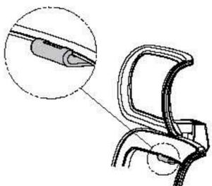
(5). 用力將蓋板鉤子部分卡住背框，如圖示，聽到“喀噠”一下，蓋板部定完成。
