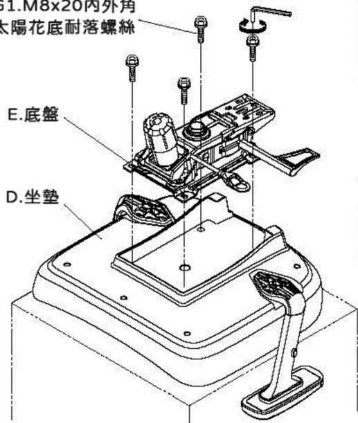
將坐墊翻轉過來放置在工作檯等穩定的地方，將底盤孔位對準坐墊相應的孔位，用M8\*20內外六角螺絲進行固定。
